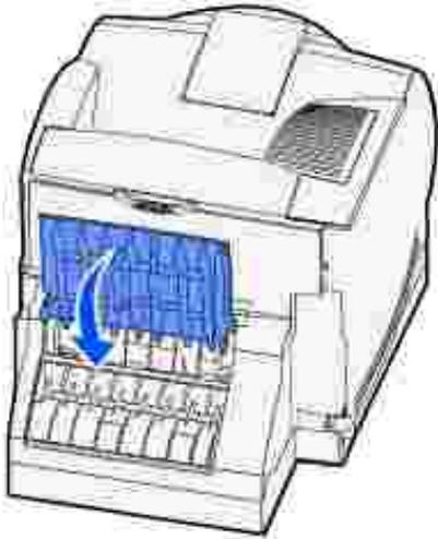
7. Appuyez sur le loquet 1 pour ouvrir la porte inférieure. Appuyez sur le loquet 2 pour ouvrir la porte supérieure.
