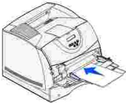
3. Faites glisser le guide de largeur vers la gauche jusqu'à ce qu'il touche légèrement la pile de support d'impression. Ne pliez *pas* le support d'impression.
