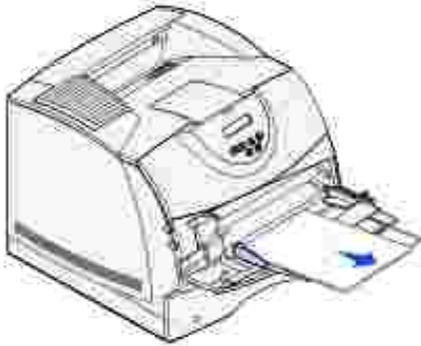
2. Repoussez la barre métallique pour refermer le chargeur multifonction en position courte.
